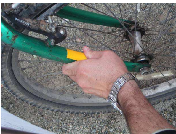
Figura 5 - Colocação das fitas refletivas.
